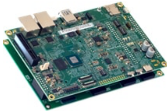
Figure 4 : Le kit de cartes d'évaluation pour le RZ/V2N inclut une carte de processeur, une carte d'extension et deux cartes secondaires, ainsi qu'un kit de développement logiciel pour l'IA. (Source de l'image : Renesas Electronics Corp.)
