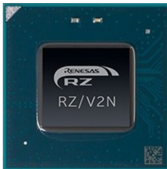
Figure 1 : Le microprocesseur RZ/V2N de Renesas offre aux concepteurs de nouvelles options pour intégrer l'IA de vision dans les applications périphériques. (Source de l'image : Renesas Electronics Corporation)
