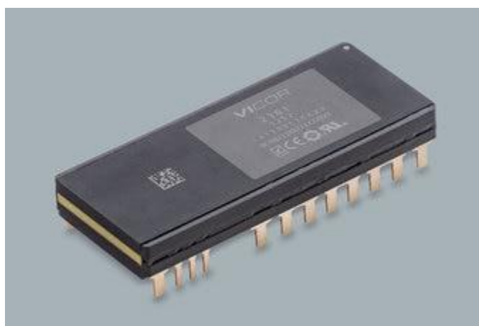
Figure 7 : Le module convertisseur de bus à rapport de conversion fixe BCM6123 offre une tension de sortie de 24 V et un courant de sortie de 62,5 A, le tout dans un boîtier ChiP™ mesurant 61,0 x 25,14 x 7,26 mm
