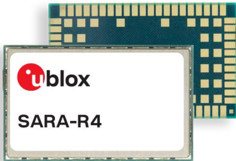
Figure 3 : les modules SARA-R4 d'u-blox sont disponibles au format miniature SARA LGA (26,0 mm × 16,0 mm, 96 broches) (Source : Mouser Electronics)
