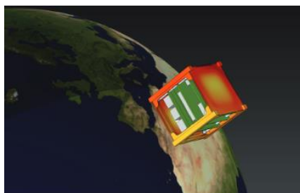
Figure 1 : Simulation du transfert de chaleur d'un satellite en orbite, montrant la distribution de la température. Crédit image de la Terre : Visible Earth et NASA.
