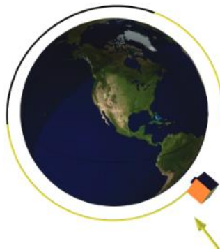
Figure 3 : Visualisation d'un satellite en orbite, montrant la position et l'orientation par rapport au Soleil et à la Terre, ainsi que l'irradiation sur les faces exposées du satellite.
