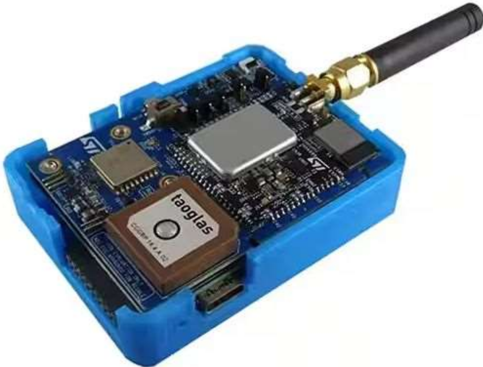
Figure 3 : La plateforme STEVAL-ASTRA1B inclut tous les outils matériels, micrologiciels et logiciels nécessaires pour développer des systèmes de suivi avancés. (Source de l'image : DigiKey)
