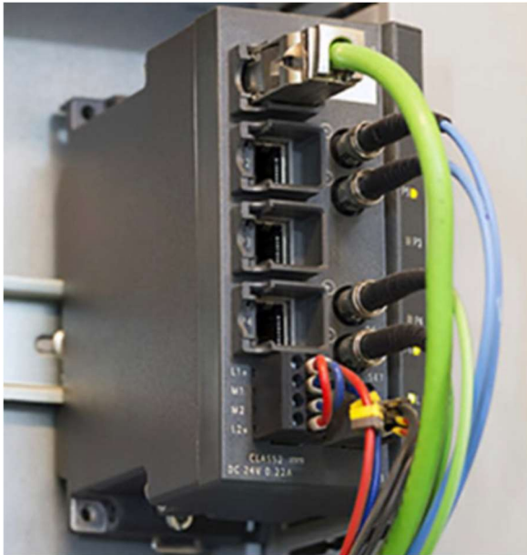
Figure 1 : Les commutateurs Ethernet contrôlent l'accès au réseau pour limiter la congestion et maintenir le débit. (Source de l'image : Amphenol)
