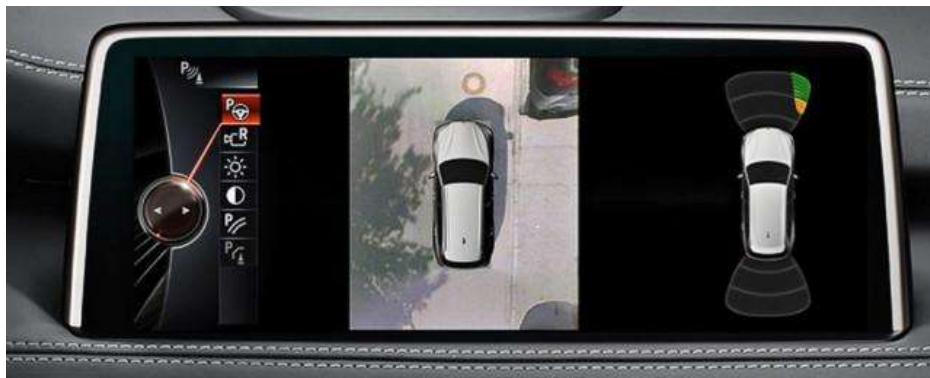
Figure 2. Exemple de système de vision panoramique, avec l'autorisation d' ExtremeTech
