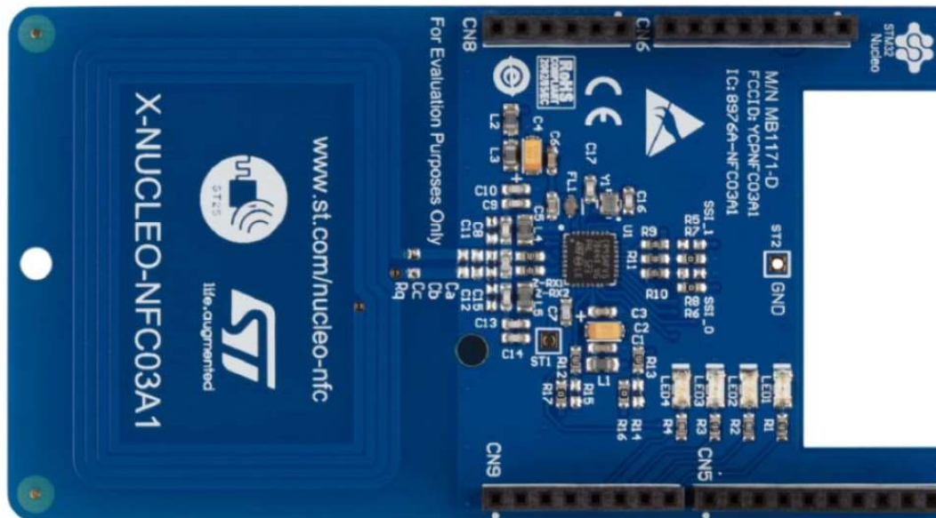
Figure 4 : La carte d'évaluation de lecteur de carte X-NUCLEO-NFC03A1 permet d'étendre les cartes STM32 Nucleo pour NFC avec prise en charge des normes de proximité. (Source de l'image : STMicroelectronics)
