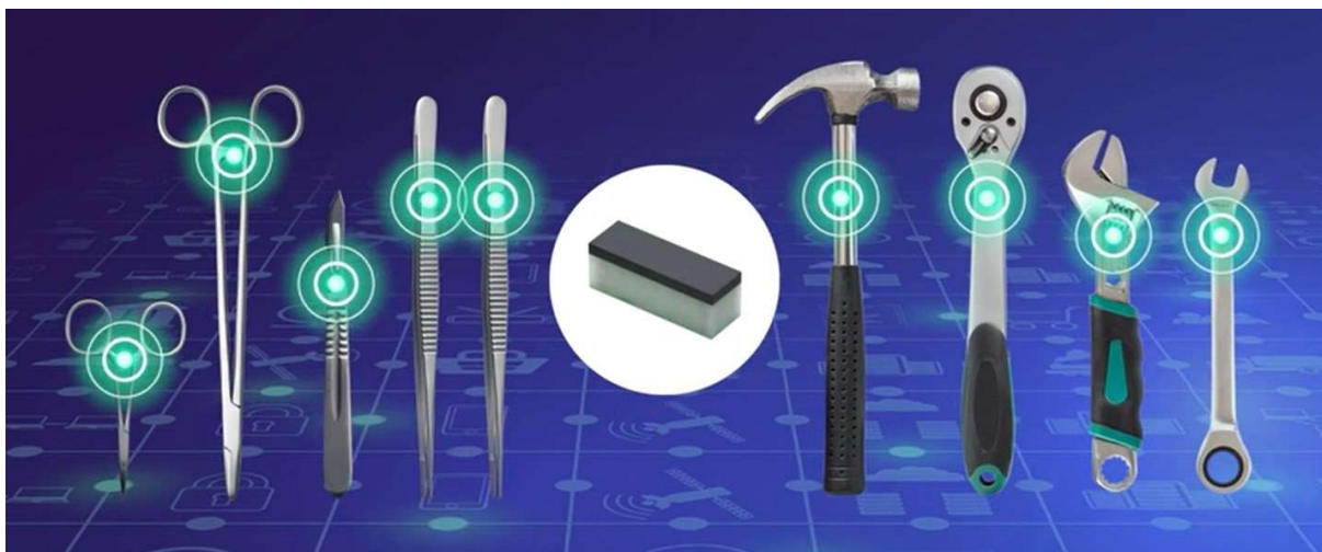
Figure 5 : Les surfaces métalliques des instruments et outils chirurgicaux sont utilisées par l'étiquette RAIN RFID UHF sur métal LXTBKZMCMG-010 de Murata comme antenne amplificatrice pour augmenter la portée de lecture. (Source de l'image : Murata)
