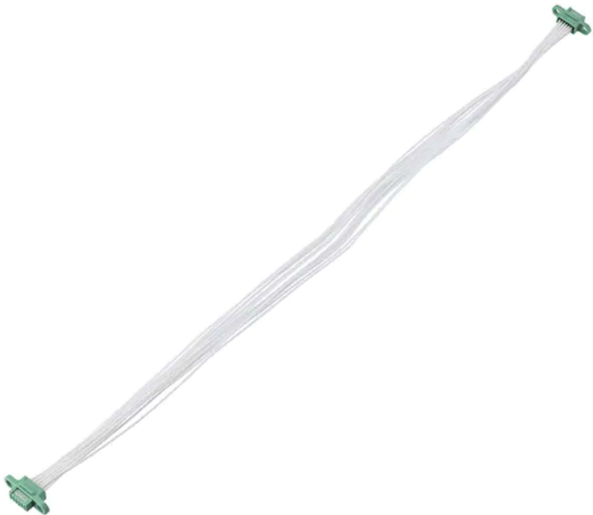
Figure 13 : Le câble et l'assemblage global constituent l'interconnexion complète. Ce G125-FC11205F0-0150F0 est un assemblage de câble à 12 positions de 150 mm de long, pour les interconnexions prise-à-prise rectangulaires, et il est disponible en tant que composant standard. (Source de l'image : Harwin)
