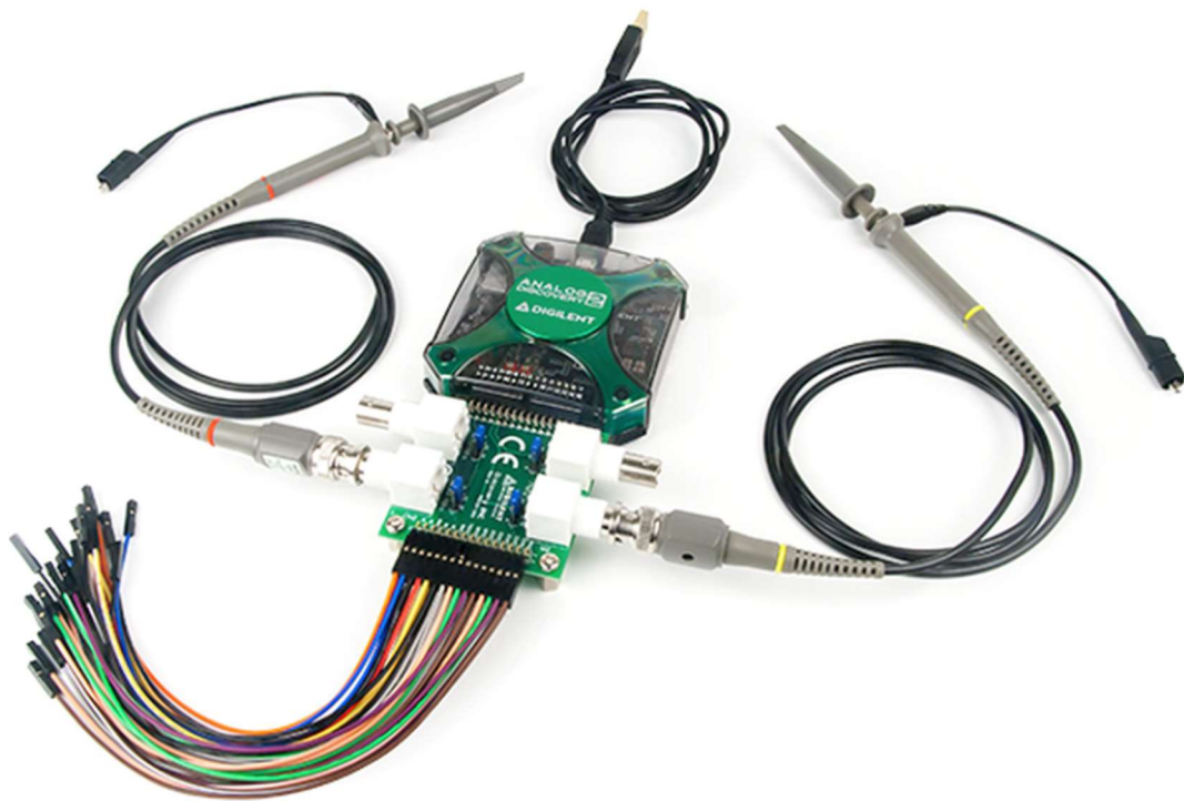
Figure 2 : kit « Analog Discovery 2 Pro Bundle » de Digilent (source : Digilent)
