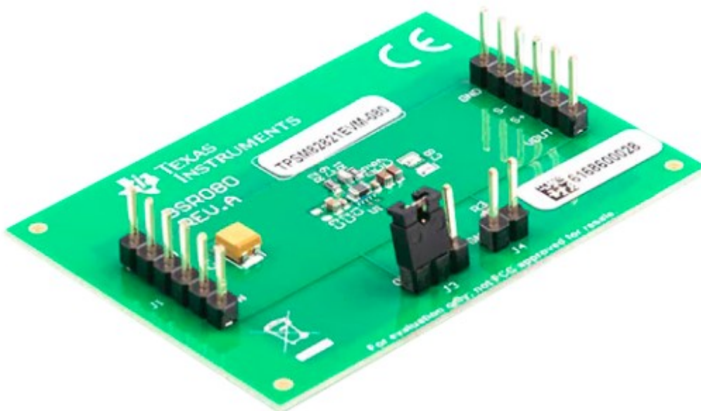
Figure 3 – La carte d'évaluation TPSM8282xEVM-80. (Source : TI)
