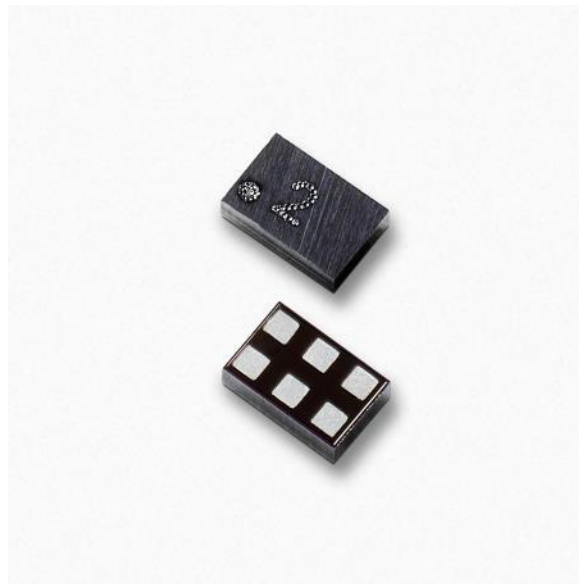
Image 3. Les réseaux diodes TVS bidirectionnels à cinq voies de la série SP1012 offrent une protection fiable contre les très dangereuses décharges électrostatiques. Leur configuration bidirectionnelle assure une protection symétrique en présence de signaux en courant alternatif.
