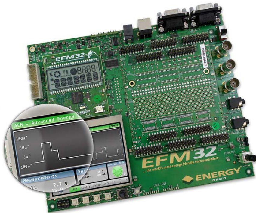
Figure 1: Kit de développement pour le microcontrôleur « éco-énergétique » EFM32 Gecko avec système de gestion évoluée de la consommation AEM (Advanced Energy Monitoring).
