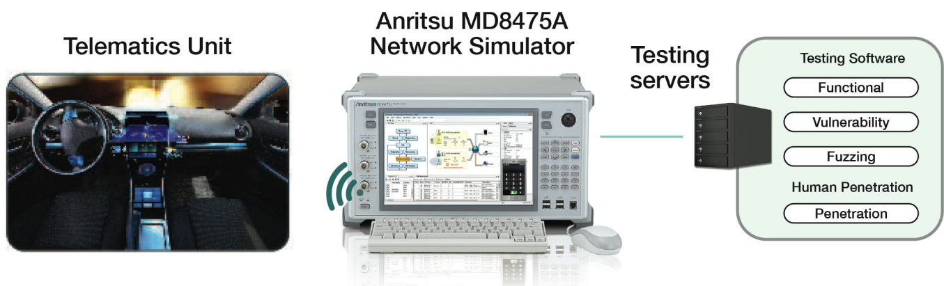
Figure 4 : Utilisation de serveurs de tests avec logiciel avec des simulateurs de réseaux
