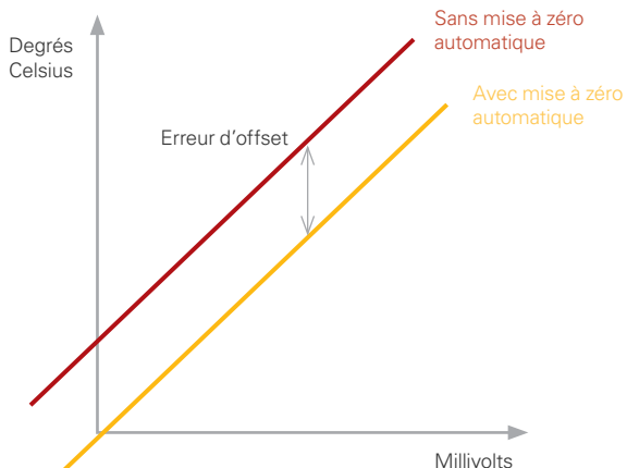
Figure 3. La mise à zéro automatique compense les erreurs d'offset au niveau du matériel de mesure.
