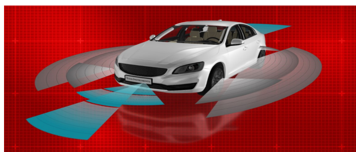
Figure 2. Les ADAS ouvrent la voie aux véhicules autonomes avec leurs radars à faible, moyenne et longue portée, lidars et caméras, utilisés pour détecter et surveiller l'environnement du véhicule.
