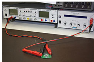
Figure 2. Montage avec câbles torsadés courts.
