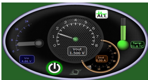
Figure 2. Contrôle simple par tableau graphique sous LTpowerPlay.
