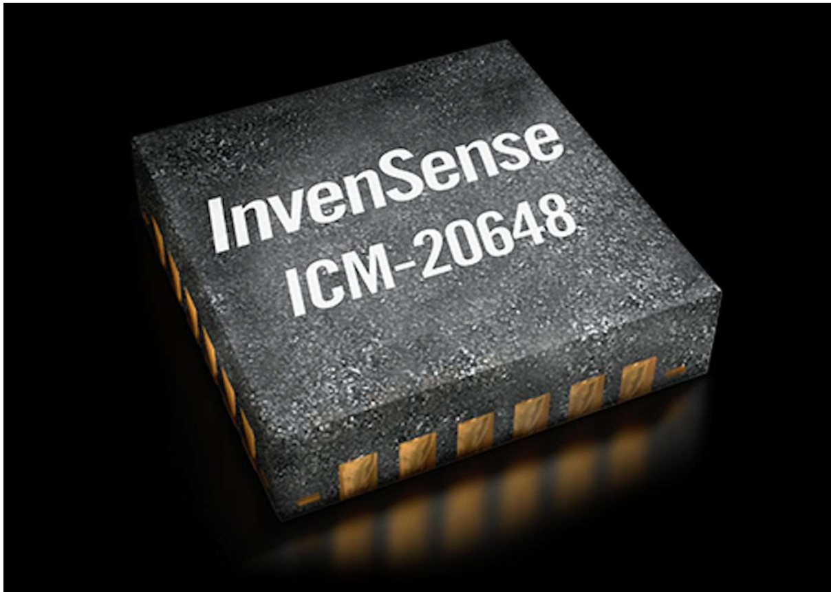
Figure 2 : puce d'accéléromètre/gyroscope ICM-20648 d'InvenSense pour les appareils portables.
