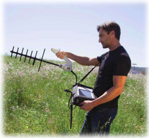
Figure 5. (a) Antenne directionnelle fixée à la poignée du système Interference Hunter, permettant de localiser la source d'un signal
