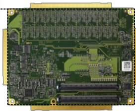
Fig 2: De Rugged COM Express à COM Express standard: Si on omet les ailes sur les quatre bords extérieurs, les deux standards ont le même facteur de forme. MEN propose les deux versions.
