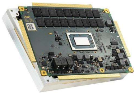
Fig 1: Équipé du processeur AMD Ryzen Embedded, le module CB71C de MEN Mikro Elektronik est actuellement le plus puissant des systèmes Rugged COM Express.
