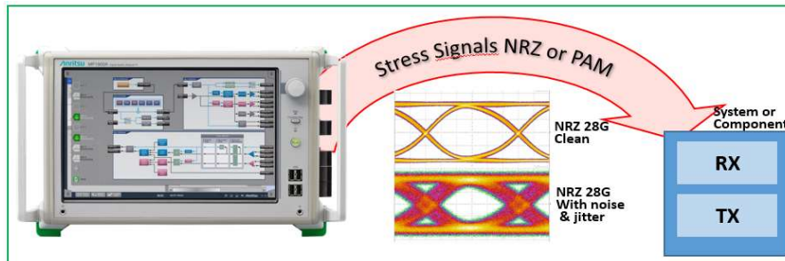
Figure 3. Le MP1900A génère les signaux requis pour les tests sous contraintes
