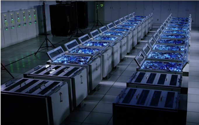
Figure S1. Le supercalculateur à refroidissement liquide par immersion Gyoukou d'ExaScaler/PEZY ZettaScaler-2.2.
