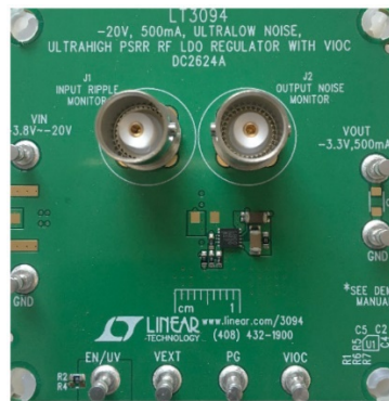
Figure 2. Circuit de démonstration comprenant un composant à -3,3 V de faible encombrement
