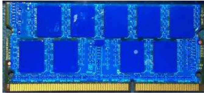
Figure 3. Vernis de protection sur un module de mémoire.
