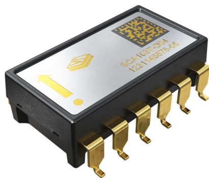
Figure 4: Le SCA103T est l'inclinomètre le plus précis et disponible en production de masse
