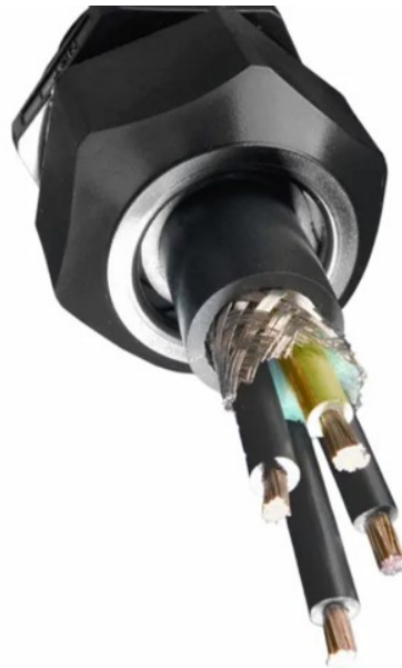
Figure 6 : Le câble VF16006 BK005 d'Alpha Wire est conçu pour des applications VFD. Il peut supporter jusqu'à 52 A par conducteur et utilise un blindage par feuille/tresse. (Source de l'image : Alpha Wire)
