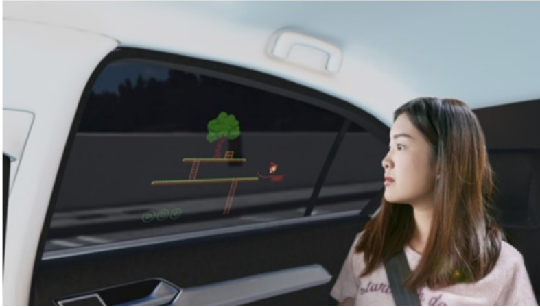
Figure 1 : Exemple d'affichage transparent sur un VTC
