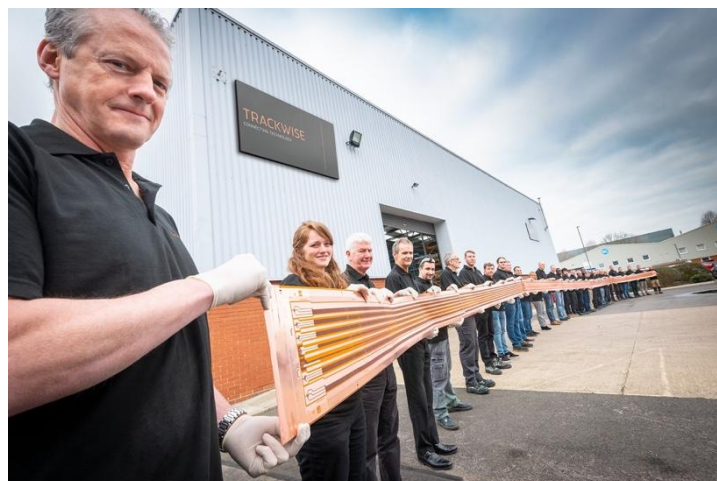
Figure 3 : Un circuit imprimé flexible multicouche de 26 mètres de long pour un UAV
