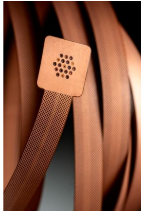
Figure 2 : Les circuits flexibles peuvent remplacer les systèmes de câblage complexes et s'intégrer parfaitement dans ou autour des composants de la voiture, tels que les phares ou les cadres de porte.
