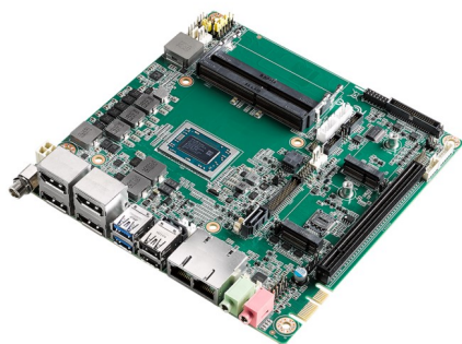
Figure 1: Efficacité: Advantech a équipé ses cartes mères Mini-ITX basées sur les processeurs AMD Ryzen Embedded R1000 / V1000 d'un connecteur PCIe Goldfinger situé sur le côté du PCB, où la logique FPGA est connectée dans les applications de jeux.
