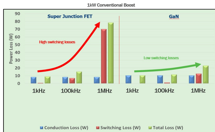
Figure1 : GaN optimisé pour la commutation rapide
