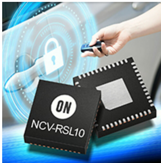
Figure 4 - Le NCV-RSL10 d'ON Semiconductor fournit une connectivité Bluetooth Low Energy pour l'automobile
