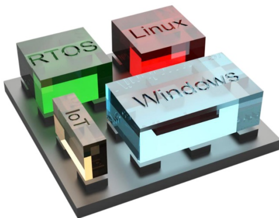
Légende 2 : L'hyperviseur RTS permet à plusieurs systèmes d'exploitation temps réel et généralistes de fonctionner sur des machines virtuelles avec un processeur multi-cœur X86.
