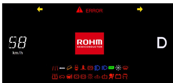
Illustration 4 : Affichage de l’instrument combiné en mode réduit sans vidéo d’arrière-plan.
