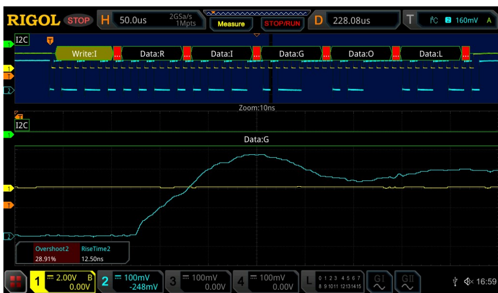
Figure 8 : Zoom sur un signal I2C pour mesurer le temps de montée et analyser la gigue.
