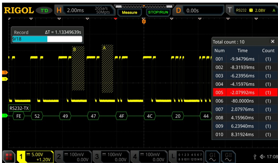
Figure 9 : Déclenchement par zone et exploration du bus RS-232, avec enregistrement de 18 images de 50 Mpoints chacune, incluant le décodage du bus RS-232
