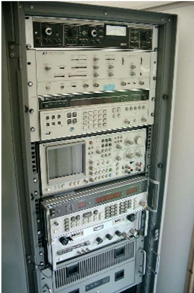
Figure 2 : Les blocs d'alimentation de table sont utilisés sur le banc d'essai des ingénieurs, mais ils sont aussi souvent montés en rack avec d'autres unités de test pour fournir un ensemble complet d'instruments. (Source de l'image : UKARANet, United Kingdom Amateur Radio Astronomy Network)
