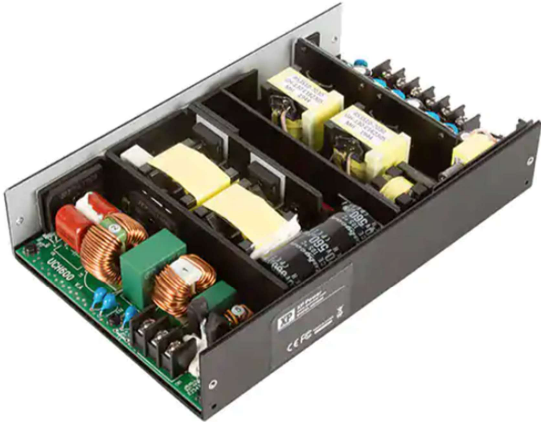
Figure 1 : Une alimentation à cadre ouvert telle que l'UCH600PS36 est conçue pour être intégrée dans le produit final sans offrir d'accès à l'utilisateur final ou d'ajustement des divers paramètres de performances. (Source de l'image : XP Power)
