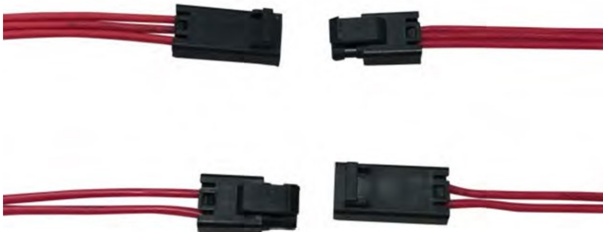
Figure 7 : Pour les LED et d'autres applications de connecteurs exigeant un indice de protection IP67, la série FLH avec la prise rectangulaire à trois fils FLH-P31-00 (en haut à gauche) et la fiche rectangulaire FLH-S31-00 correspondante (en haut à droite) est disponible, ainsi que des versions à 2, 3, 4 et 6 broches. (Source de l'image : Amphenol ICC)
