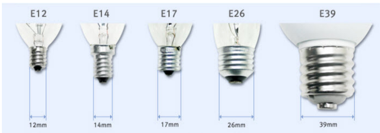
Figure 1 : Le culot Edison E26 de 26 mm est de loin le culot d'ampoule le plus utilisé, bien qu'il en existe de plus petits et de plus grands pour répondre à diverses exigences d'application. (Source de l'image : LOHAS LED Ltd.)
