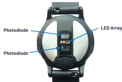
Figure 5. Montre ADI VSM V4, membrane de séparation, LED et photodiode
