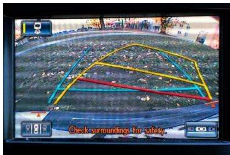
Figure 3 : exemple de vue d'une caméra de recul avec des lignes. Ces lignes correspondent à des trous dans la transmission, à des paquets abandonnés. Une ou deux et on peut toujours voir l'image, mais on ne veut certainement pas qu'elle clignote en noir quand il y a un enfant derrière.
